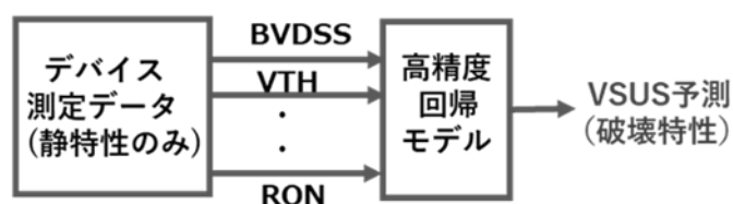
図 A-5-1. ウェハテストの静特性による VSUS (L 負荷試験) の回帰モデル化
