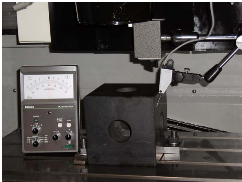
図 2-4 四直角マスタを用いた比較測定
