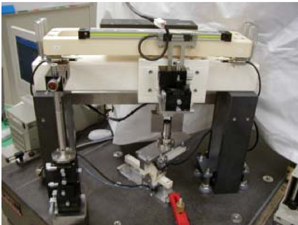
図 3 - 6 精度校正装置（校正の状態）
