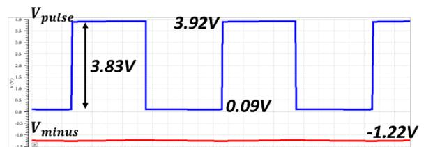
図 4.2.3 反転型チャージポンプの出力波形
