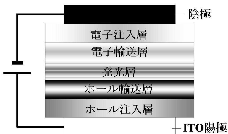
図 2-2 有機 EL の素子構造 (多層型)
