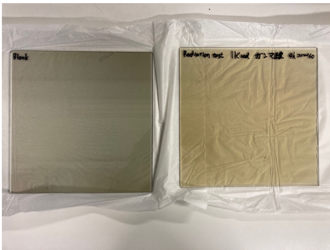
図 9-6 片面に透明導電膜を塗布したガラス (左) ガンマ線 1k Rad 照射後のガラス (右)
