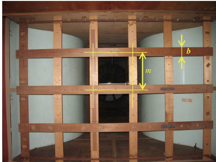
写真-7.2 乱流格子設置状況
