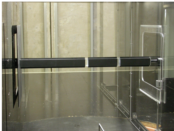
写真-5.1 供試模型 ( B/D=1 断面柱, 表面圧力・PIV実験用)
