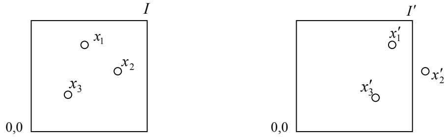
図-6.4 時刻 t で記録された輝度分布 I と \Delta t 後の t' で記録された輝度分布 I'
