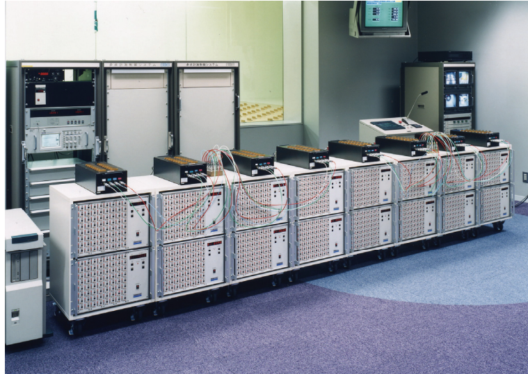
写真-5.4 多点風圧測定システム (センサー・アンプ部)
